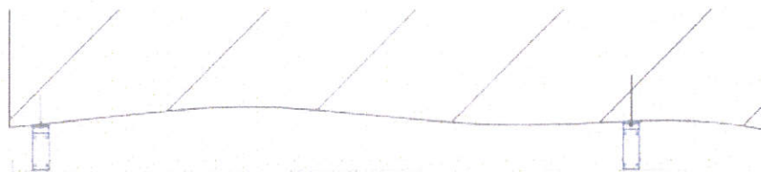
Vedere in plan a ecliselor si a riglelor montate pe perete Detaliu Scara 1:5
